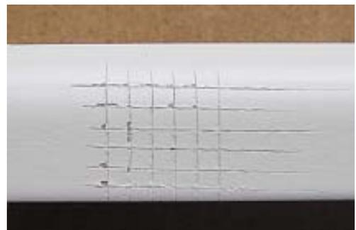
Bild: Gitterschnitt an einer Schmalfläche
